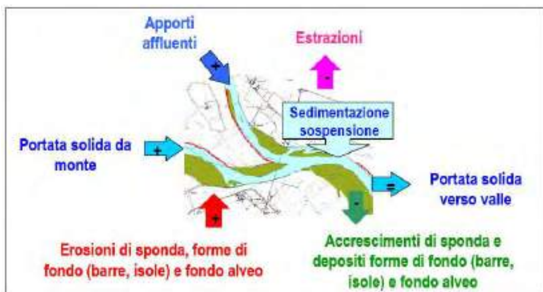
Figura 38 - Schema modello di analisi del bilancio del trasporto solido.
